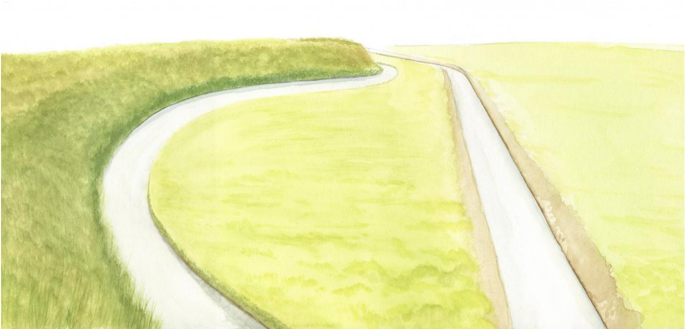
Figuur 19 Weergave van de ligging van een watergang voor (links) en na (rechts) het verleggen van die watergang om te voorkomen dat bevers in de voet van een waterkering graven. © D. Klees
